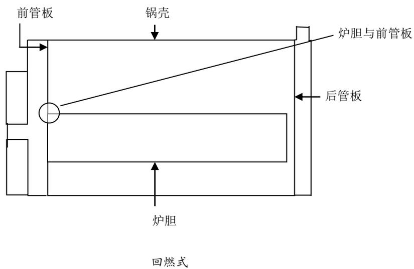
图 3-1 不允许采用 T 型接头连接的部位
