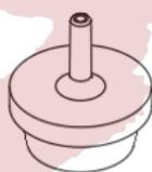
图5 内塞结构示意图
