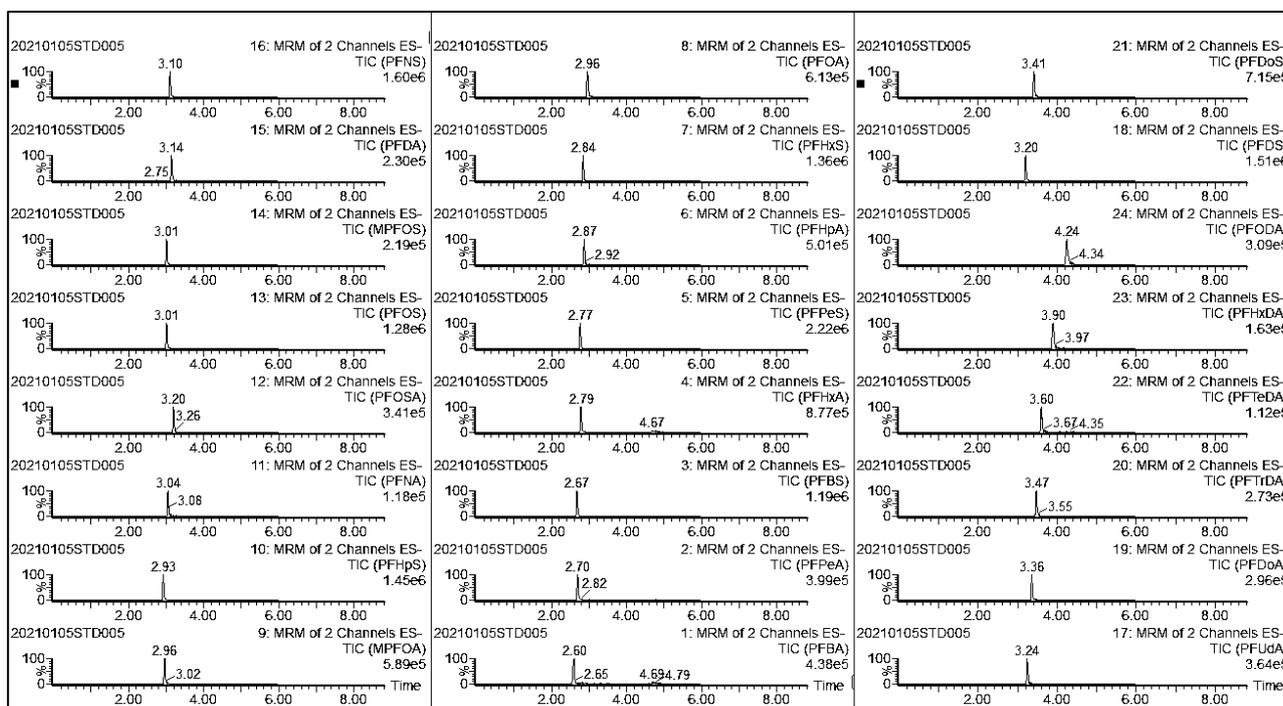
图 1 空白样品中添加 5  $\mu\text{g}/\text{kg}$  水平 22 种 PFASs 及内标总离子流图
