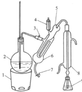
图 A.1 定氮蒸馏装置图
