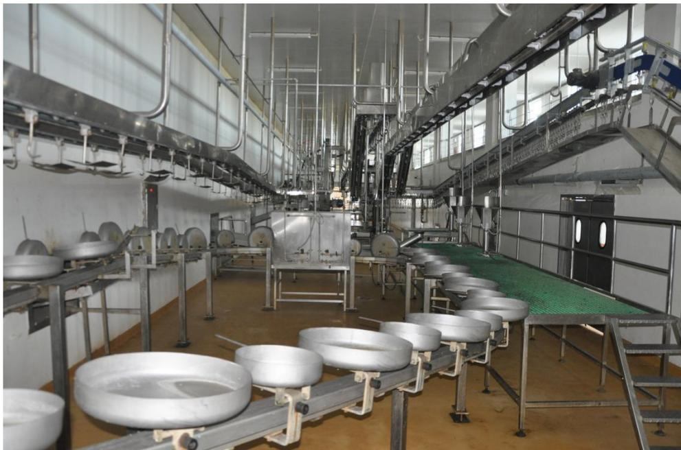
图 A.2 落地式同步检验输送设备
