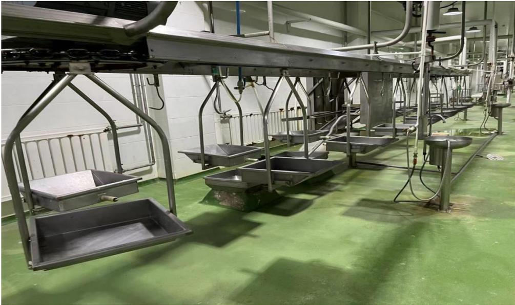
图 A.1 悬挂式同步检验输送设备
