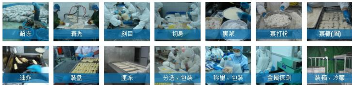
图2 速冻裹衣鱿鱼加工工艺流程
