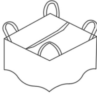
图 A.6 带进料槽、进料口的集装箱上盖
