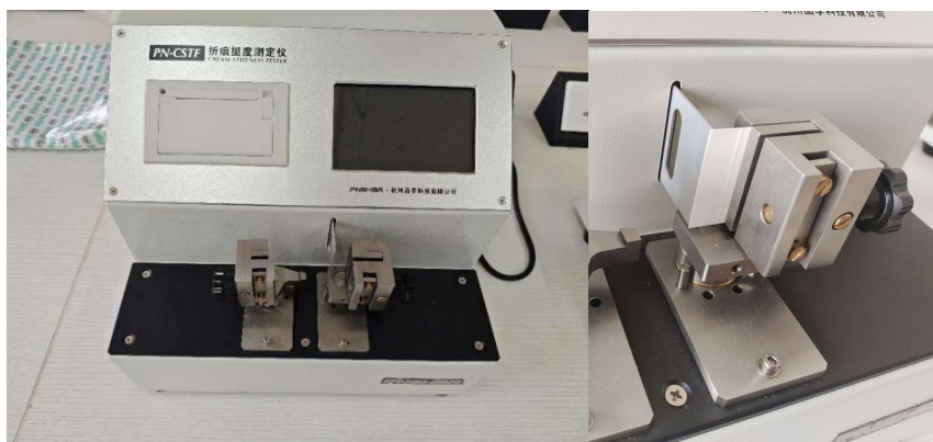
图 2 折痕挺度测试仪
