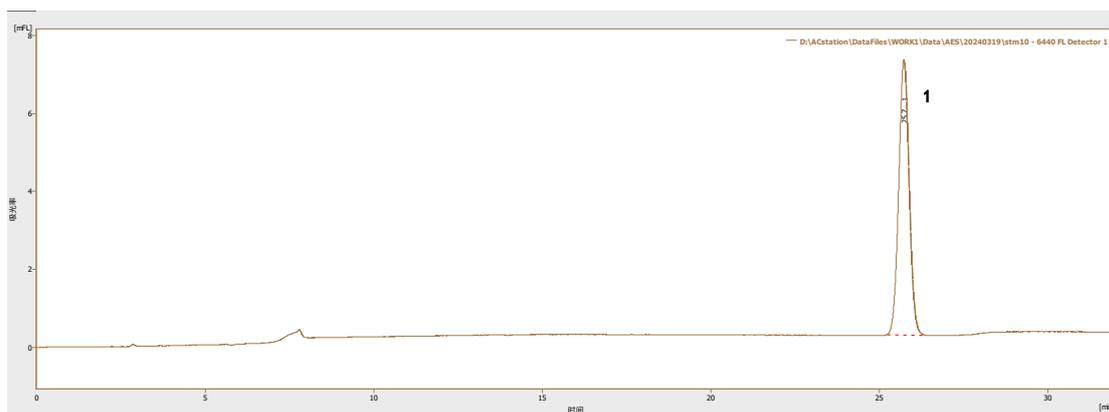
图 A.2 乙氧酰胺苯甲酯 (0.5  $\mu\text{g/mL}$ ) 标准溶液的高效液相色谱图
