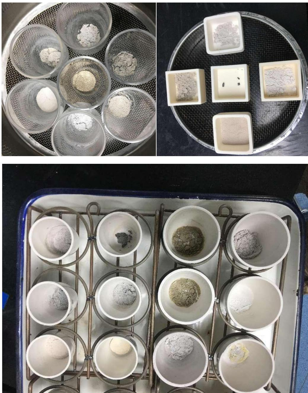
图 3 石英坩埚、方形刚玉坩埚、瓷坩埚不同样品灰分颜色展
