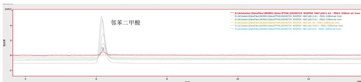
图 18 邻苯二甲酸标准系列溶液液相色谱图
