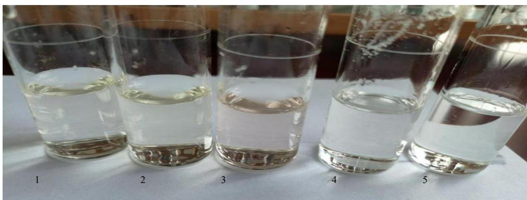
图6 易炭化物试验
