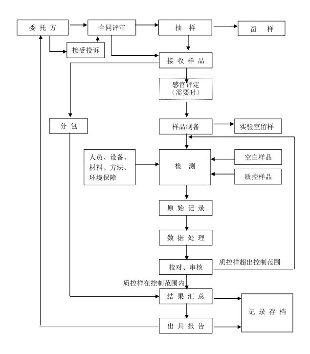
图 C.1 食品理化检测实验室工作流程控制图
