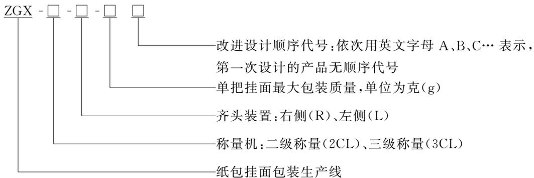
示例: ZGX-2CL-L-1000 A 表示配置二级称量机、齐头装置在左侧的单把挂面最大包装质量为 1 000 g 的纸包挂面包装生产线,第一次改进设计。
