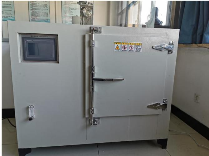
图 1 堆积粉尘自燃温度测定实验装置
