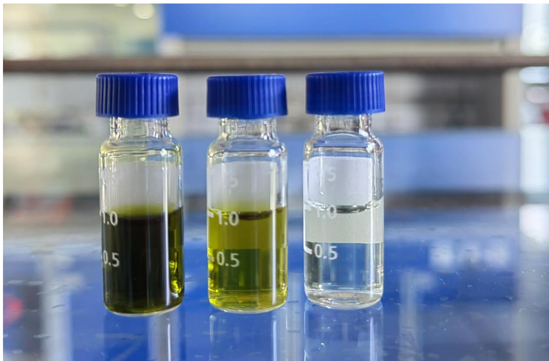
图 9 青贮饲料未净化、HLB 净化和 GCB+HLB 净化对比
