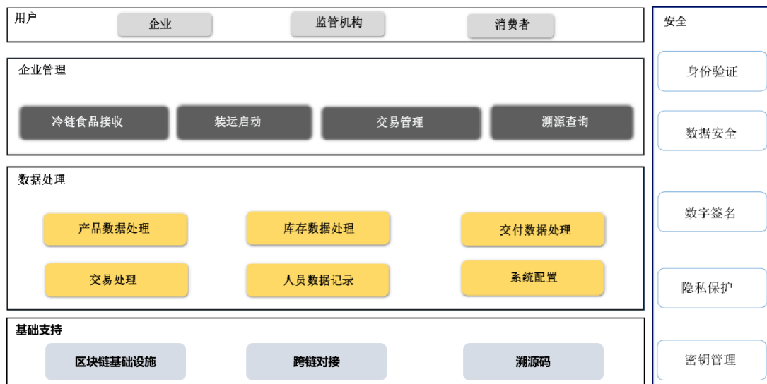
图 2 基于区块链的冷链食品溯源平台框架
