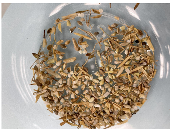
图 2 过 2.0mm 圆孔筛，留存在 1.5mm 圆孔筛的筛上杂质（1.4 倍拍摄）
