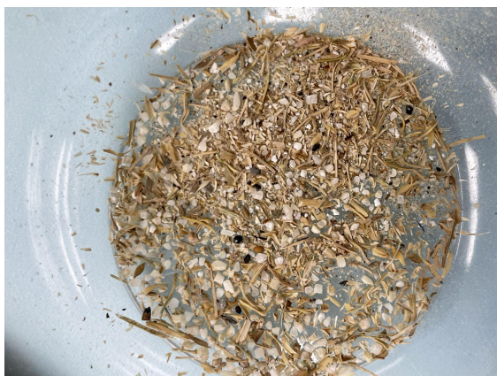
图 1 过 1.5mm 圆孔筛的筛下杂质（1.4 倍拍摄）
