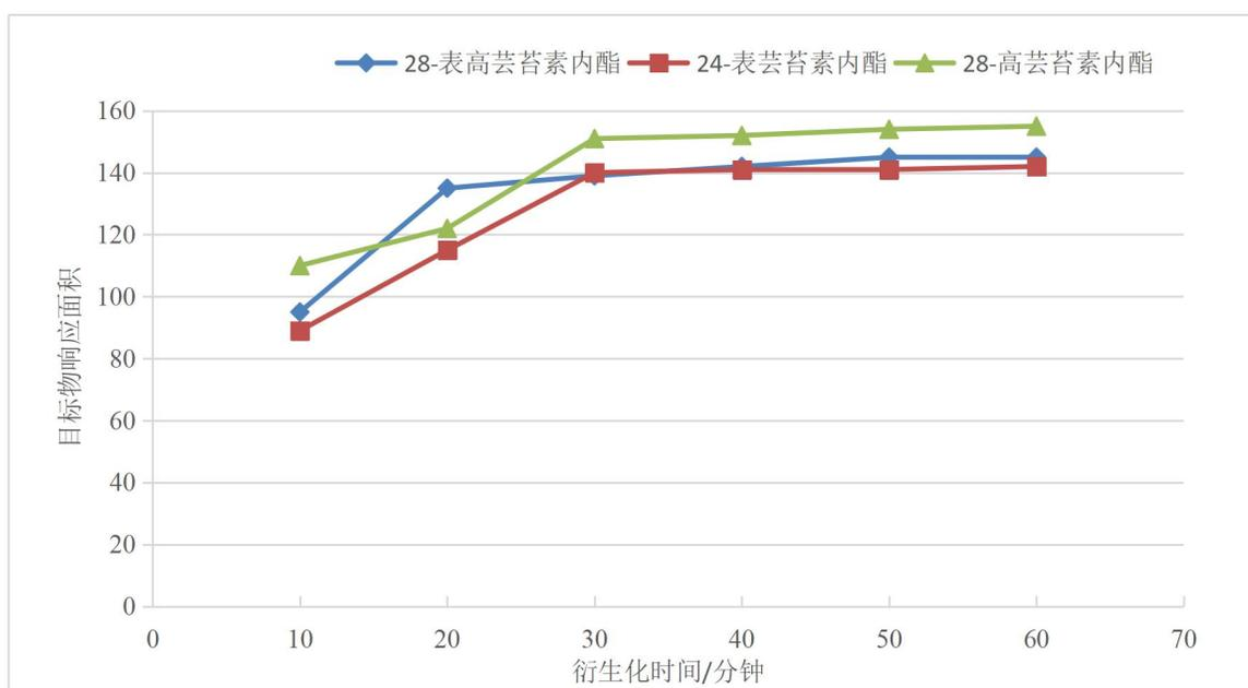
图 5 不同衍生化时间下待测物液相色谱响应峰面积
