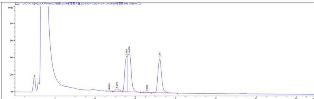
(b) 以 Column 2 (C<sub>18</sub>, 4.6mm×150 mm, 5.0 μm) 为分离柱
