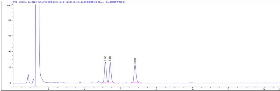
(c) 以 Column 3 (C<sub>18</sub>, 4.6 mm×100 mm, 2.7 μm) 为分离柱
