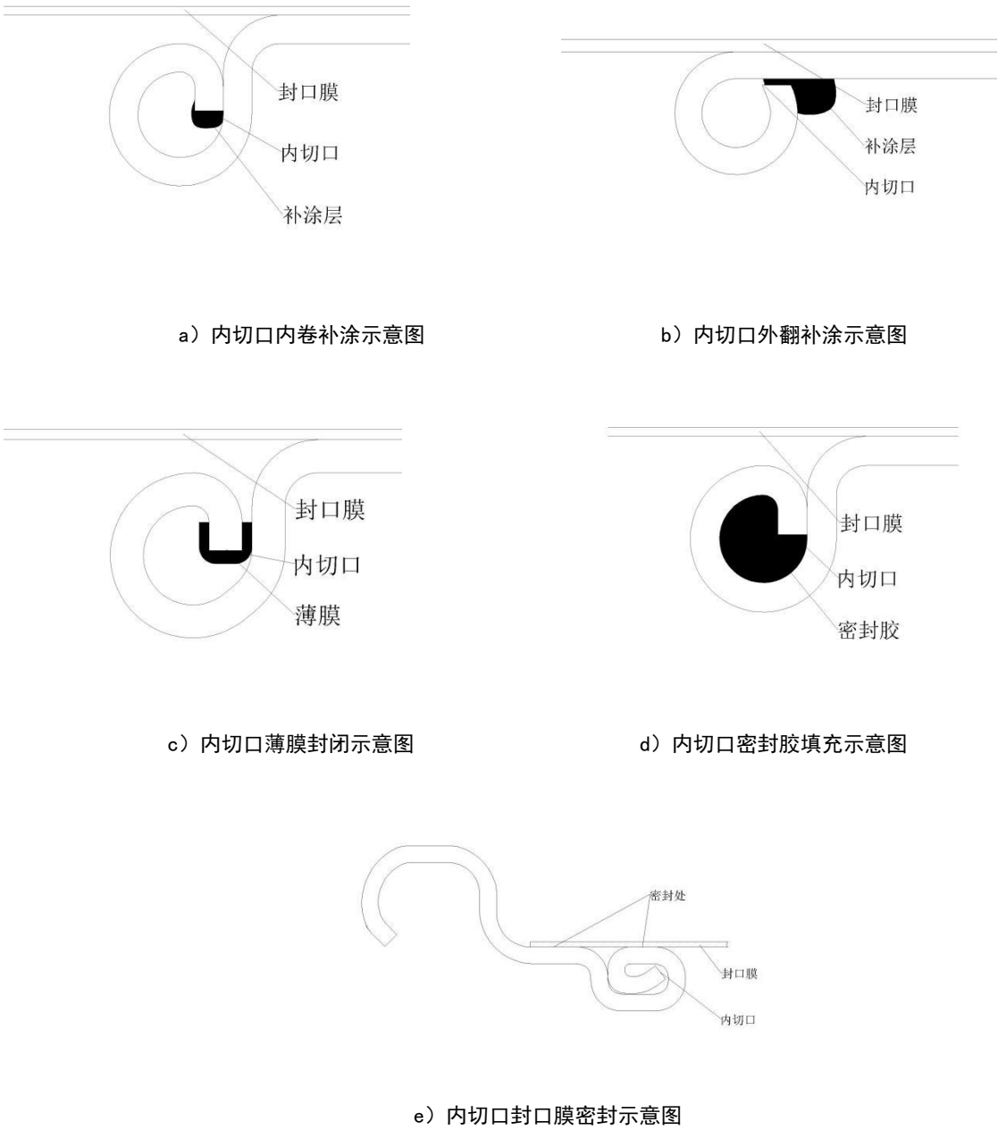
图C.1 易撕盖内切口封闭处理的结构示意图
